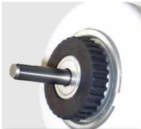
Sisäyksikön viheltävä ääni - vaihde uusi puhallinmoottori
